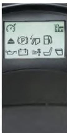
**ЖК-дисплей** отображает ряд параметров: наработку часов эксплуатации, напряжение аккумулятора, готовность травосборника к работе, уровень топлива в баке, момент опустошения травосборника, подключение косилочного механизма, круиз-контроль.
